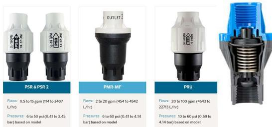
A função de um regulador de pressão é a de reduzir o efeito da variação de pressão da água à entrada do aspersor sobre o caudal debitado, independentemente das variações de pressão do sistema devido a alterações nas condições hidráulicas, elevações no terreno, oscilações na bombagem, etc.
